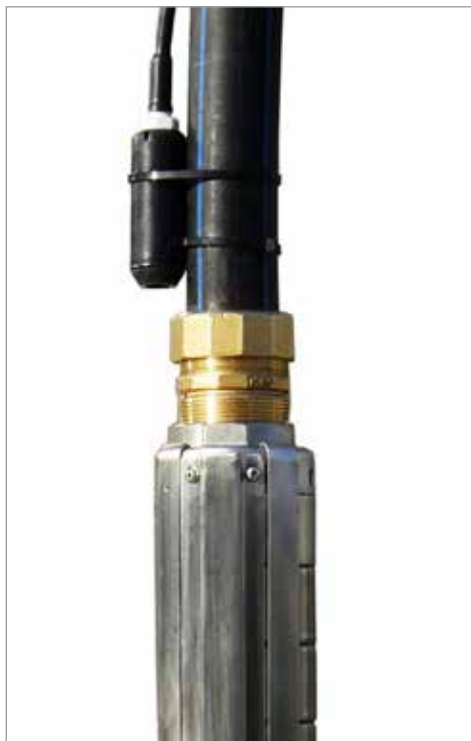
Figure 48: fixation de la sonde de puits
